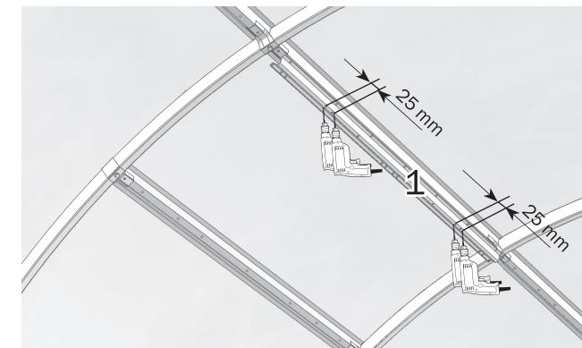
Paigaldage ülemised hinged ülemisele latile.
