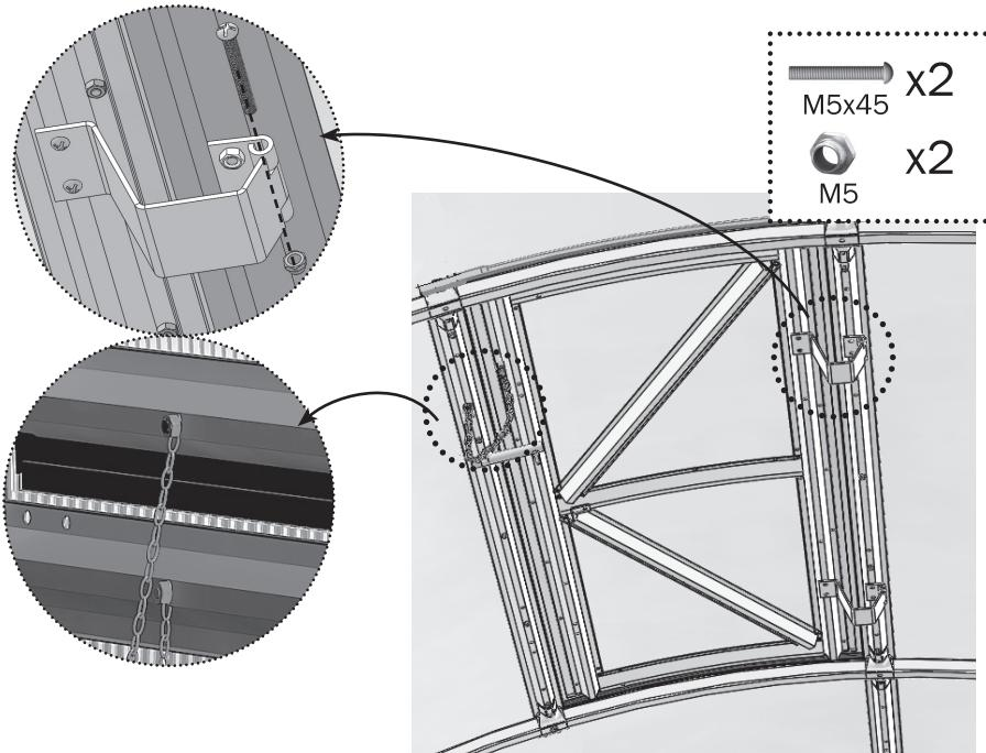
Kett kinnitatakse kruvide külge ja see hoiab akent tuuleiilide korral paigal.
