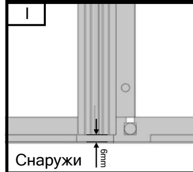
Оставьте зазор в 6 мм при креплении внутренней дуги (с "А"-образным каркасом) на нижнем боковом порог.
